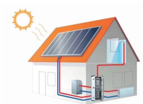
Slika 9.4: Na levi strani prikaz ogrevanja in priprava tople sanitarne vode v kombinaciji s sončnimi kolektorji, ter desno prikaz toplozračnih sončnih kolektorjev.
