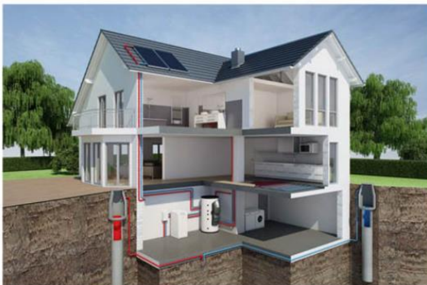
Slika 9.18: Prikazuje izkoriščanje toplote iz podtalne vode.
